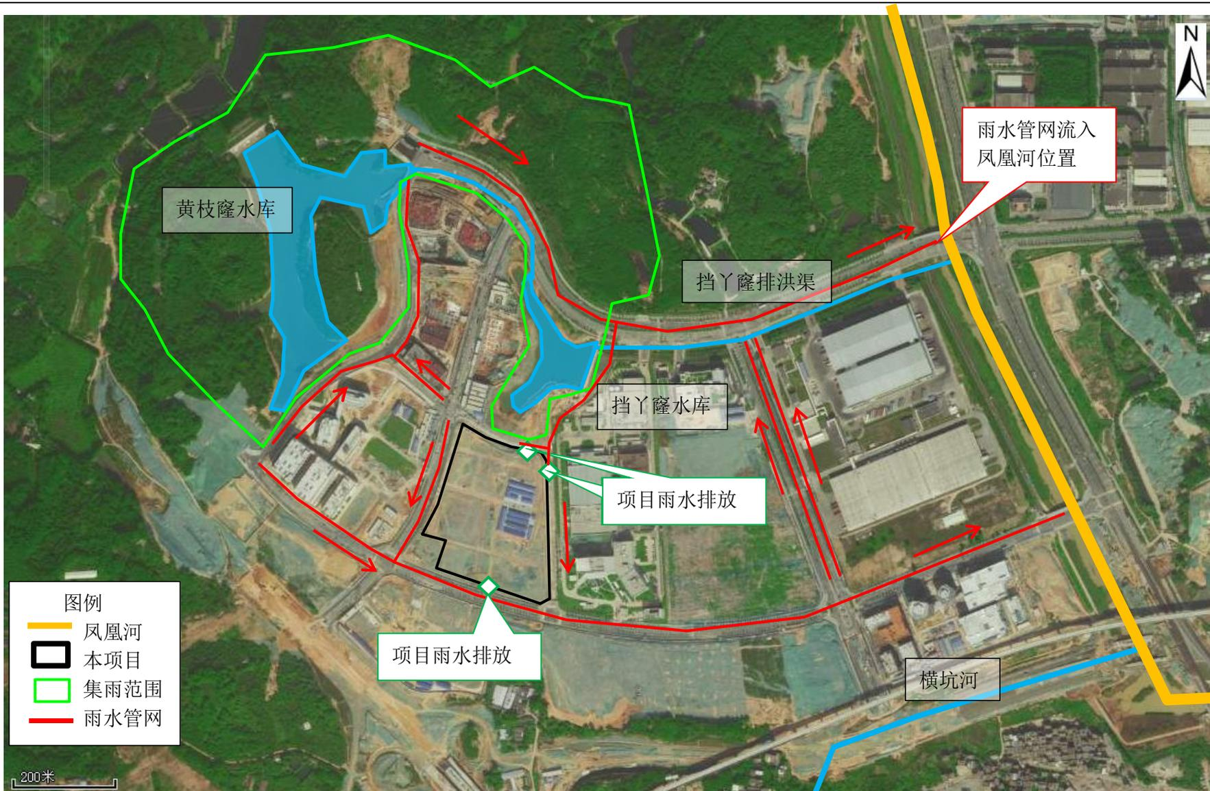
图6.3-1a 项目周边雨水管网图（来自《黄埔区给排水系统专项规划（2019-2035）图集》及现场实际建设情况）
